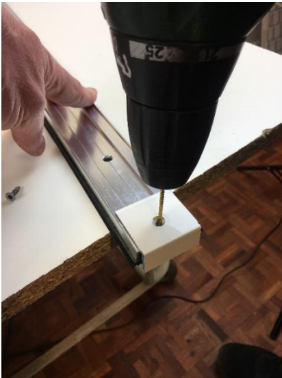
Der forbores med et 3mm bor i trykprofilen
