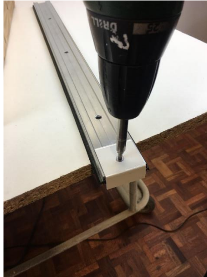
Profilafslutningen monteres på trykprofilen
